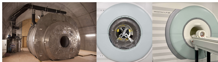
Figure 1 : aimant 11.7T lors de sa première montée au champ nominal, après insertion de la bobine de gradient et après intégration des équipements d'imagerie (de gauche à droite)
